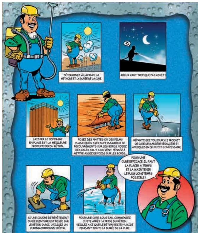
Extrait du dépliant "sept conseils pour la mise en oeuvre du béton prêt à l'emploi" de FedBeton. Disponible sur le site [www.fedbeton.be](http://www.fedbeton.be).
