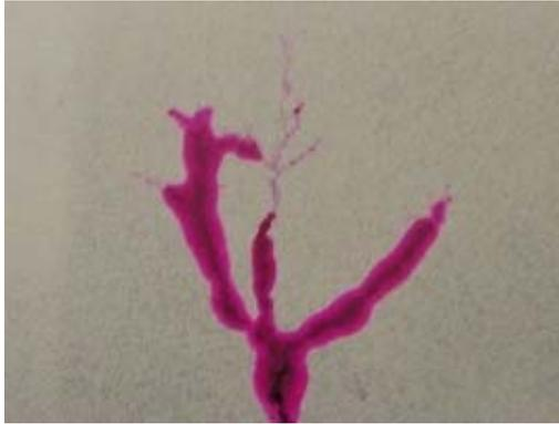
Figure 5 : Technique par magnétoscopie
