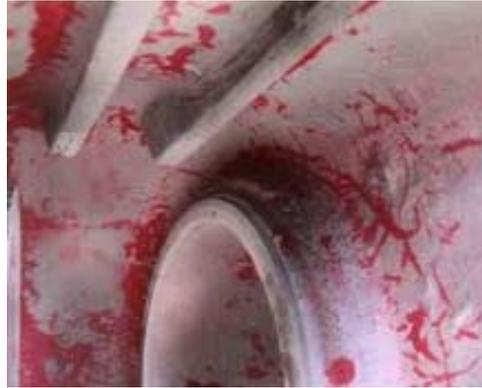
Figure 6 : Technique par pénétration d'un colorant
