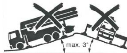
Figure 22 : Nivellement de la pompe
