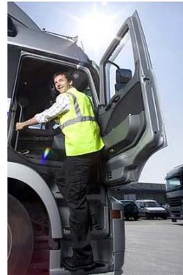
Figure 16 : 3 point de contacts pour l'entrée et la sortie
