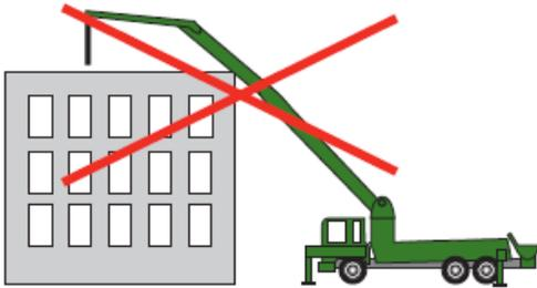
Figure 33 : Ne pas laisser reposer la rampe sur une structure
