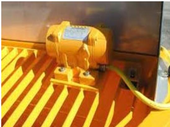
Figure 9 : Grille de trémie et vibreur
