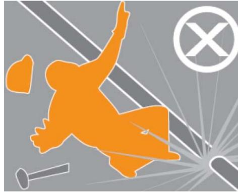
Figure 36 : N'ouvrez jamais un pipeline qui est sous pression
