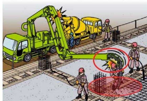
Fig. K4 : Illustration d'une défaillance de rampe et d'une zone de danger se trouvant juste en-dessous d'une rampe
