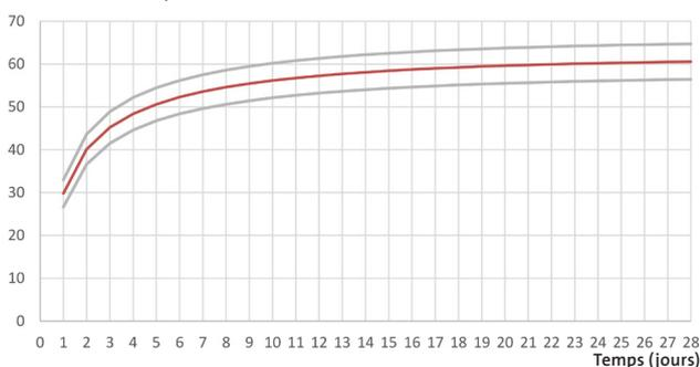
La figure donne l'évolution de la résistance à la compression sur cube de 150mm d'arête d'un béton standard<sup>(1)</sup>, obtenue dans notre laboratoire, sur un béton à base de CEM I 52,5 N (ng). Les caractéristiques principales du béton sont :
