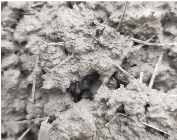
Dankzij de aangepaste samenstelling en de homogene verdeling van de vezels is het beton makkelijk verpompaar.
