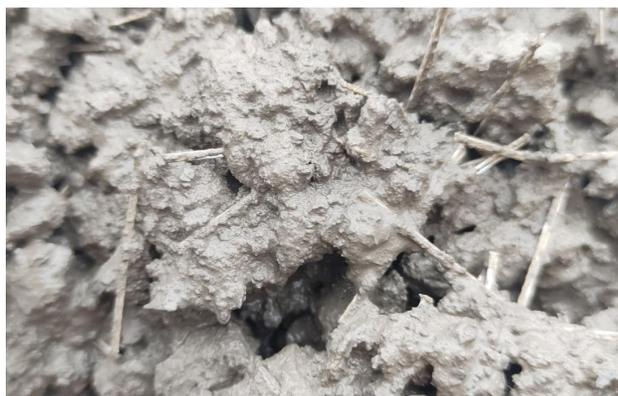
La composition adaptée et la répartition homogène des fibres rendent le FIBEROC facilement pompable
