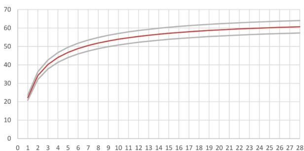
La figure donne l'évolution de la résistance à la compression sur cube de 150 mm d'arête d'un béton standard<sup>(1)</sup>, obtenue dans notre laboratoire, sur un béton à base du CEM I 52,5 N (MF). Les caractéristiques principales du béton sont :
