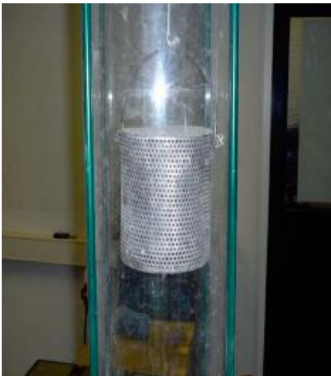
De gestandaardiseerde uitwasproef laat toe de samenhang van het beton in stromend water te evalueren
