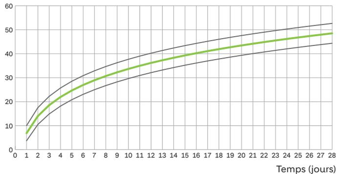
La figure donne l'évolution de la résistance à la compression sur cube de 150 mm d'arête d'un béton standard<sup>(2)</sup>, obtenue dans notre laboratoire, sur un béton à base du CEM V/A (S-V) 42,5 N LA.
