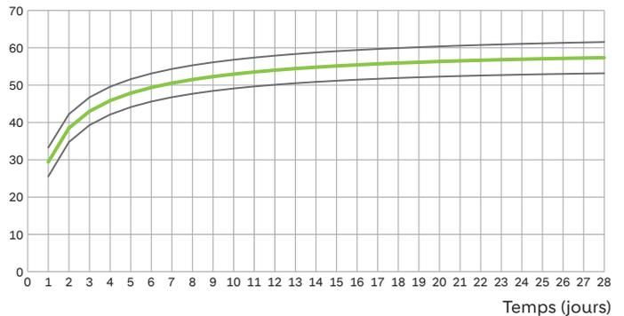
La figure donne l'évolution de la résistance à la compression sur cube de 150 mm d'arête d'un béton standard<sup>(3)</sup>, obtenue dans notre laboratoire, sur un béton à base du CEM II/A-LL 52,5 R (ng).
