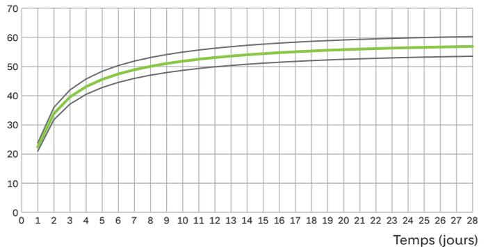
La figure donne l'évolution de la résistance à la compression sur cube de 150 mm d'arête d'un béton standard<sup>(3)</sup>, obtenue dans notre laboratoire, sur un béton à base du CEM I 52,5 N (ng).
