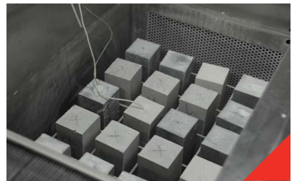
Fig 4-5-6 Essai de gel interne (gel dans l'air)
