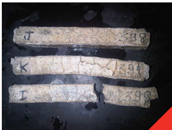
Fig 4.6.1 Dégradation d'éprouvettes de béton soumises à un test de résistance aux sulfates
