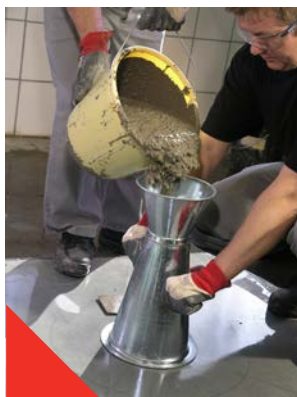
Fig 3.2.1 Mesure du slumpflow
