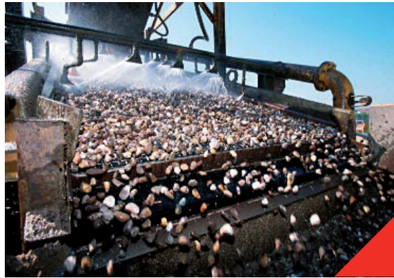
Fig 1.3.3 Lavage industriel des gravillons
