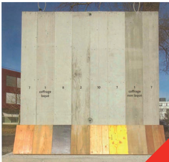
Fig 2.5.1 Exemple d'essai sur différents coffrages et utilisation de différents produits de démoulage. Le même béton a été coulé pour chaque partie
