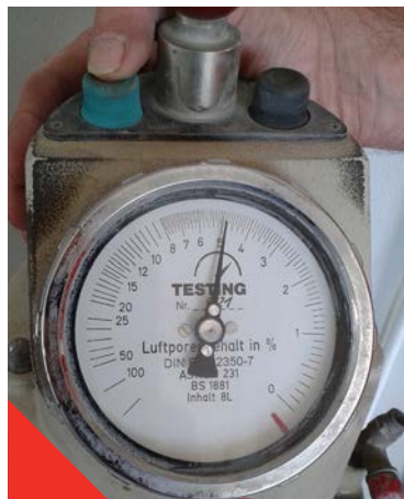
Fig 4-5-5 Contrôle de la teneur en air à l'aéromètre
