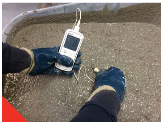
Fig 2.10.3 Mesure de la température du béton frais
