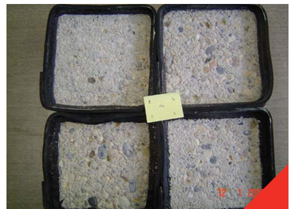
Fig 4-5-7 Echantillons après essai d'écaillage
