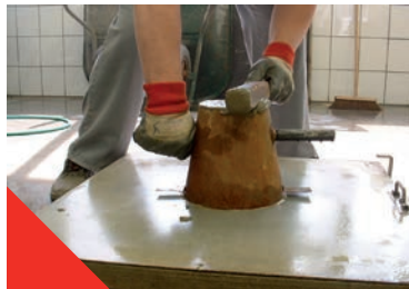
Fig 2.2.2 Mesure du flow à la table à chocs
