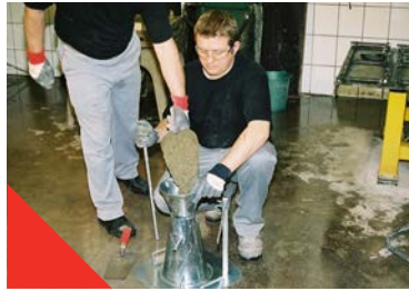
Fig 2.2.1 Mesure du slump au cône d'Abrams
