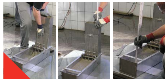
Fig 3.2.2 Essai de la boîte en L
