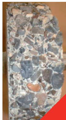
Fig 4.8.2 Slecht bestand beton - siliciumhoudende granulaten
