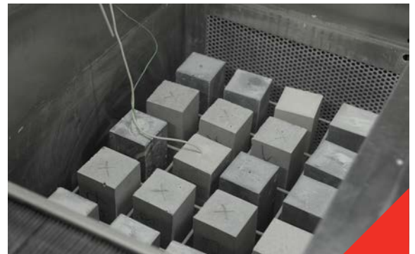
Fig 4-5-6 Proef voor de bepaling van de vorstweerstand
