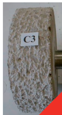
Fig 4.8.3 Slecht bestand beton - kalksteenhoudende granulaten
