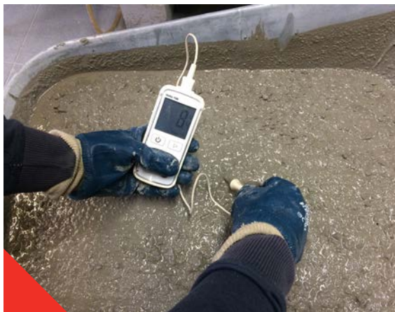
Fig 2.10.3 Meten van de temperatuur van vers beton
