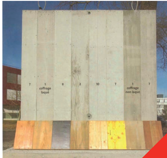
Fig 2.5.1 Voorbeeld van een proef met verschillende bekistingen en gebruik van verschillende ontkistingsproducten. Alles werd met hetzelfde beton gestort
