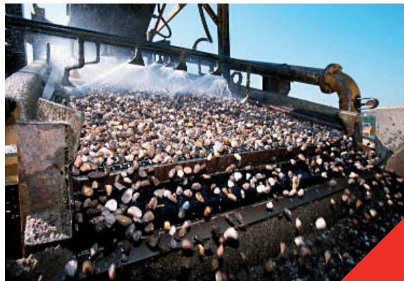
Fig 1.3.3 Industrieel wassen van grove granulaten
