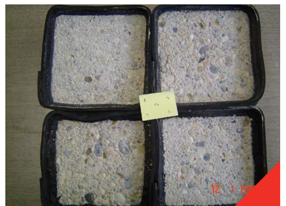
Fig 4-5-7 Proefstukken na de afschilferingsproef
