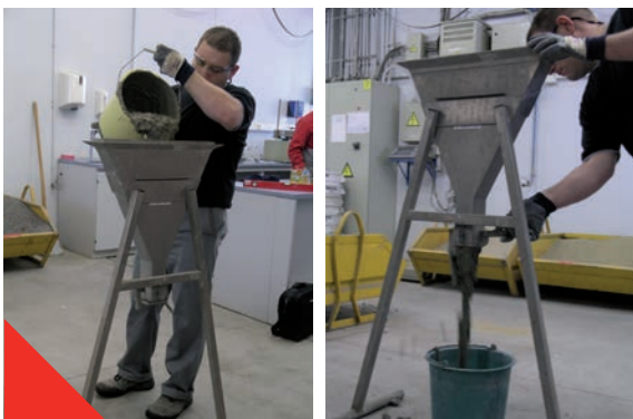
Fig 3.2.3 Meting met de V-funnel
