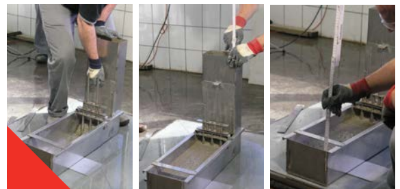
Fig 3.2.2 Meting met de L-box
