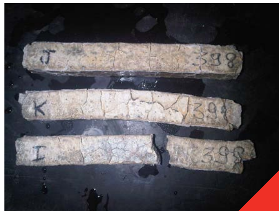
Fig 4.6.1 Sterke uitzetting van mortelprisma's onderworpen aan een sulfaatbestandheidsproef
