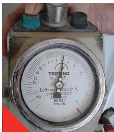
Fig 4-5-5 Controle van het luchtgehalte met de luchtmetertje
