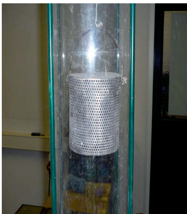
Le test de délavement standardisé permet d'évaluer la cohésion du béton dans l'eau courante
