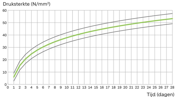
Deze figuur geeft de evolutie van de druksterkte weer van een standaardbeton<sup>(2)</sup>, gemeten in ons laboratorium, op kubussen van 150 mm zijde, aangemaakt met het cement CEM III/A 42,5 N (ng) LA.
